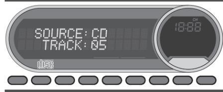
Remarque : Utilisez le ton 40 Hz à 0 dB (Piste 5) pour les applications d'amplificateur mono ou le ton 1 kHz à 0 dB (Piste 7) pour les applications d'amplificateur à canaux multiples. Veillez à ce que le croisement soit basculé sur le réglage de filtre approprié.
