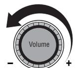
8. Den Eingangspegelregler drehen, bis die Ausgangsbegrenzungsanzeige in der entsprechenden Farbe aufleuchtet. Dasselbe für die Eingangspegel aller Kanäle wiederholen.
